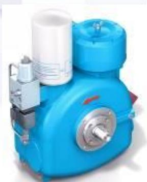
**Винтовой блок NK-31** производится компанией Rotorcomp (Германия) и является основой винтового компрессора. Визуально он представляет собой чугунный корпус, внутри которого, на подшипниках размещены два ротора, сжимающие воздух.
